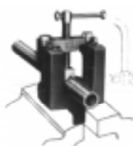
Fica fácil cortar o tubo no esquadro com o nosso dispositivo de corte EO (AV) ou TRU-KUT peça nº 710439.
