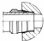
Verifique o ajuste do tubo pré-montado no encosto do tubo de um corpo de pré-montagem. Para isso, use uma conexão parcialmente partida. A face superior do tubo pré-montado deve tocar no encosto de tubo do corpo de pré-montagem.
