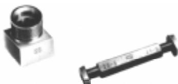
Os cones de corpo de pré-montagem VOMO estão sujeitos ao desgaste normal e têm de ser checados regularmente (depois de cada 50ª a pré-montagem) com calibres de cones quanto às suas medidas. Corpos de pré-montagem fora de medidas devem ser substituídos para evitar montagens de má qualidade.
