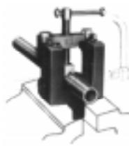
Fica fácil cortar o tubo em esquadro com nosso dispositivo de cortar tubos (AV) ou TRU-KUT peça nº 710439.
