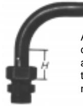
A porção reta do tubo H não deve desviar da circularidade a ponto de exceder as tolerâncias para tubos da norma DIN 2391.
