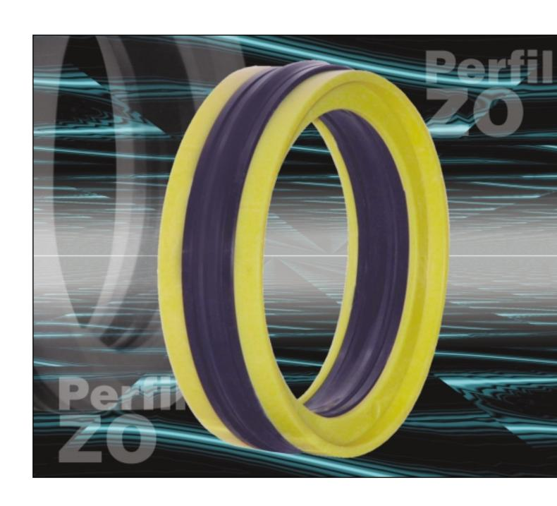
O Perfil "ZO" usado no conjunto de vedação de pistões é uma vedação de pistão de ação dupla. Ele consiste de um elemento de vedação de borracha, dois anéis anti-extrusão e dois anéis guia angulares.
